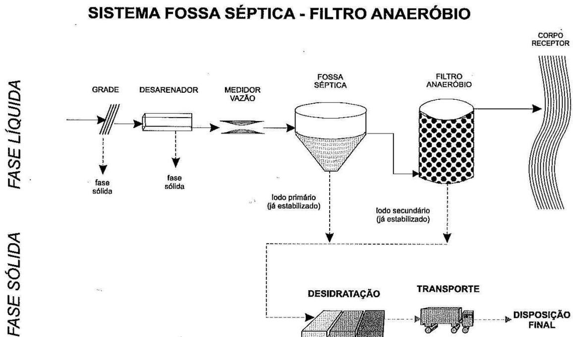
Figura 10. Fluxograma de um Sistema Fossa Séptica - Filtro Anaeróbio. Fonte: VON SPERLING (2005).
